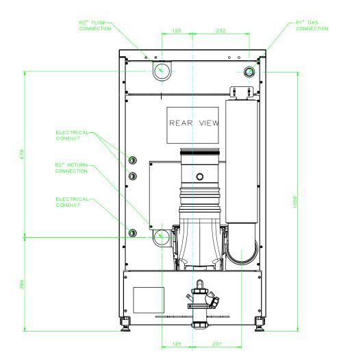
THIS DRAWING COVERS 80kW, 120kW AND 160kW BOILERS
